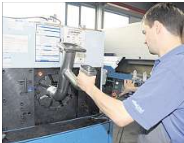
Dirk Metsch, Mitarbeiter der Dietzel-Hydraulik GmbH, verpresst einen Schlauchanschluss.
