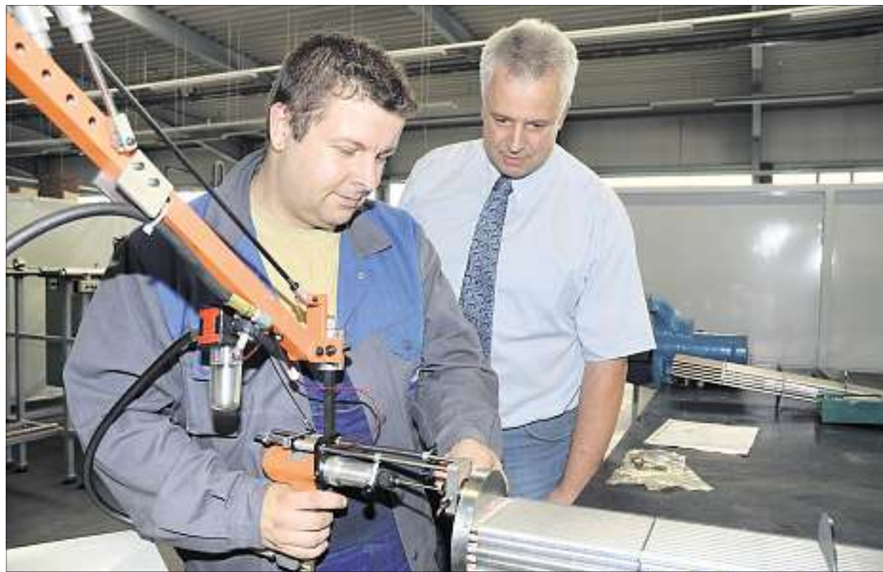
Marco Brückner, Mitarbeiter bei Dietzel-Hydraulik, montiert einen Ölkühler. Geschäftsführer Bertram Wößner sieht ihm dabei über die Schulter zu. (Fotos [2]: OTZ/Knut Lechner)
